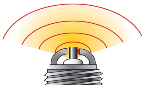
Рисунок 1. – Фронт распространения пламени в многоэлектродной свече зажигания.
