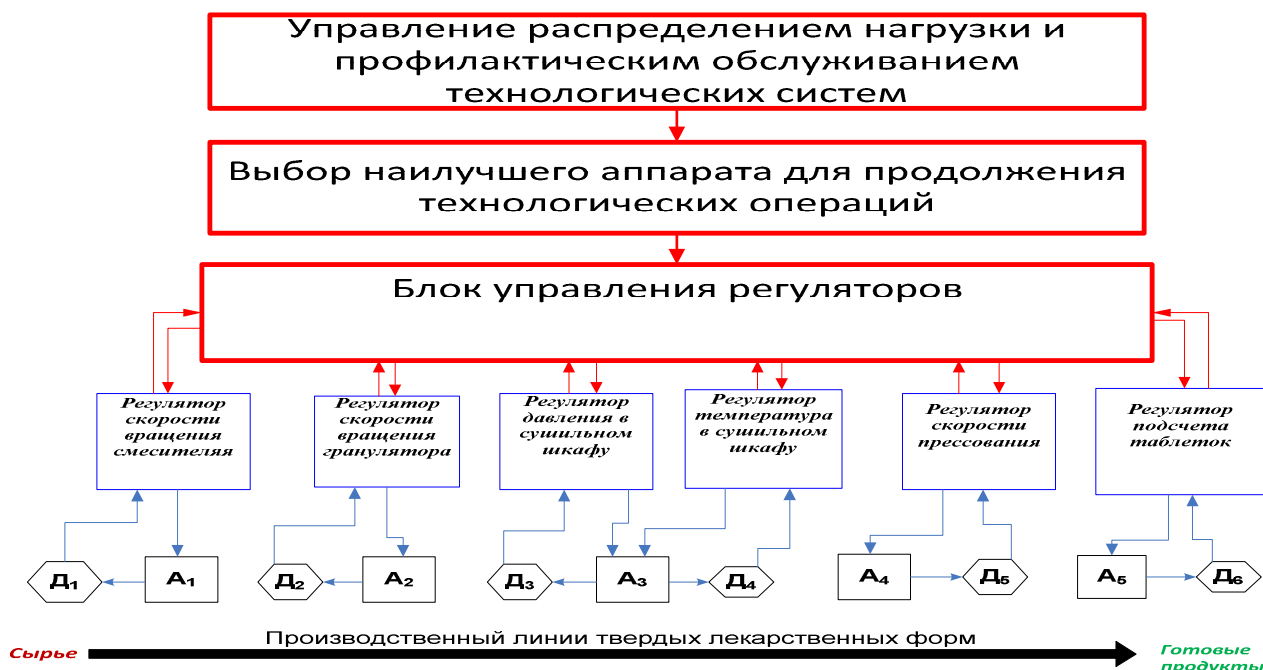
Рис.2. Структура реализации системы контроля и управления
