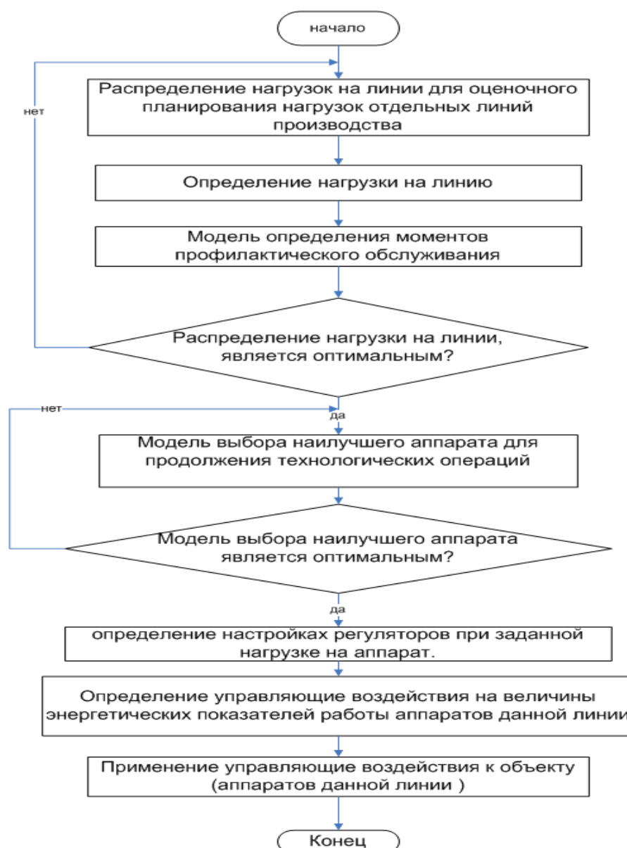
Рис.3. Методика стратегии для управления оборудованием в процессе производства твердых лекарственных форм
