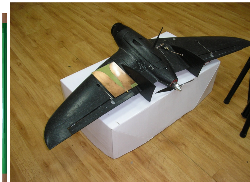
Рисунок 4. — Опытный образец оптимизированной щелевой антенны (a) и вариант его размещения на крыле БЛА (б)
