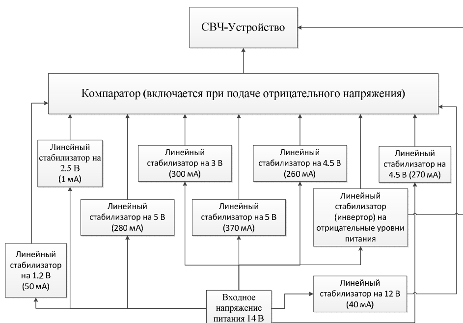
Рис. 1. Функциональная схема традиционного обеспечения питания СВЧ-модуля
