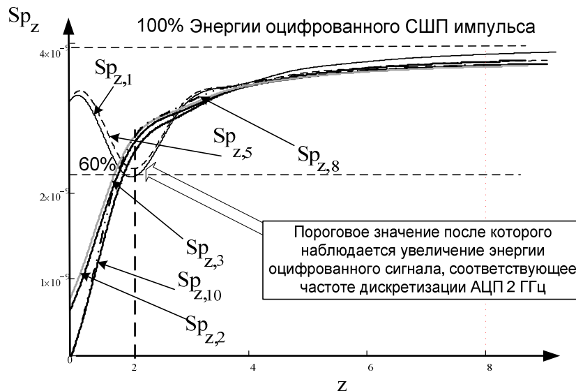
Рисунок 3 – Пример зависимости энергии оцифрованного сигнала при фиксированных значениях временных сдвигов СШП импульса длительностью 2 нс описываемого первой производной гауссовой функции
