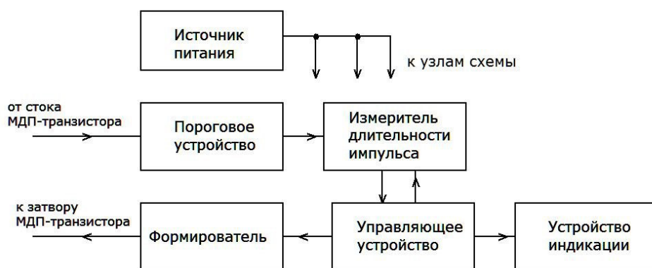
Рисунок 1 – Структурная схема устройства измерения времени запуска МДП-транзистора
