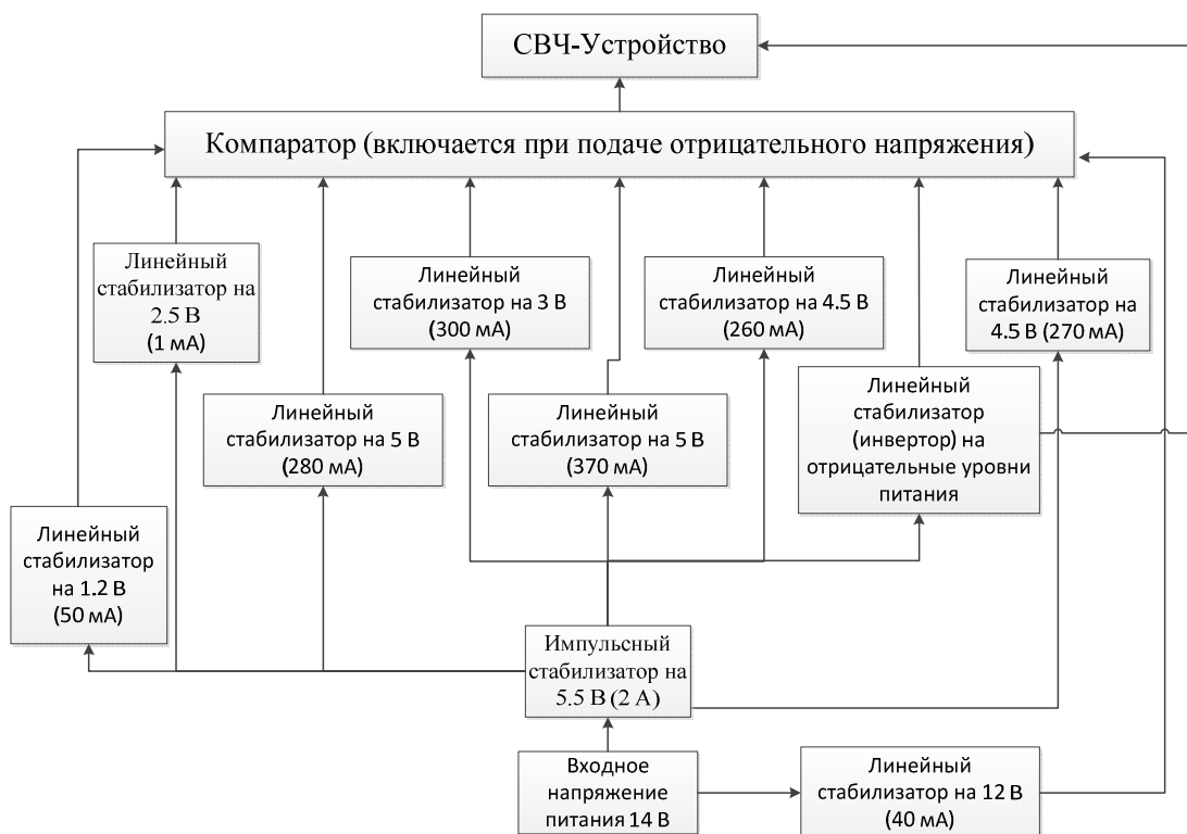
Рис. 3. Функциональная схема представленного варианта обеспечения питания СВЧ-модуля
