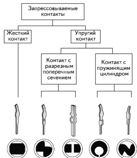
Рисунок 3 - . а) Соединение упругий «Press-Fit»; б) Классификация соединений упругой запрессовки
