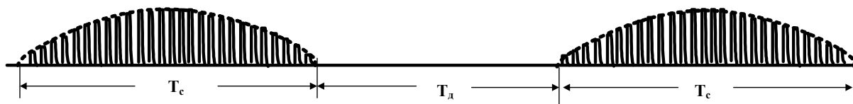
Рисунок 4. Импульсы электростимуляции с синхронизацией сердечным ритмом в полупериодном волновом режиме работы.
