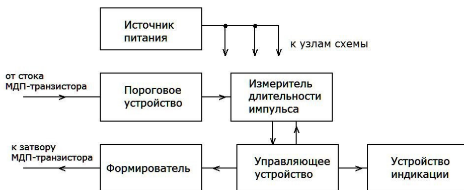
Рисунок 1 – Структурная схема устройства измерения времени запуска МДП-транзистора
