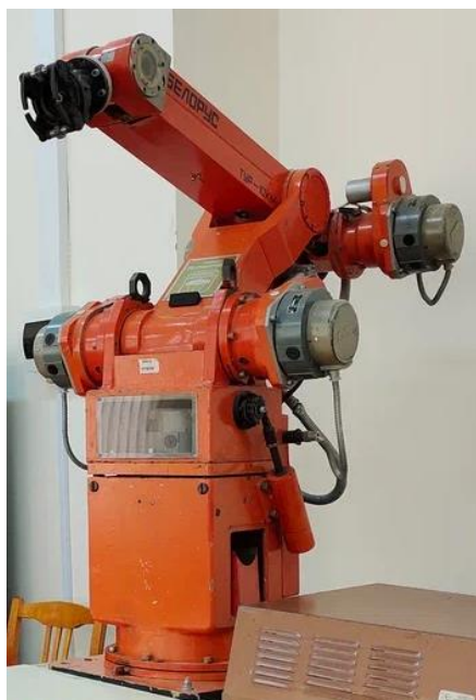
Рисунок 1 – Промышленный робот с двигателями постоянного тока
