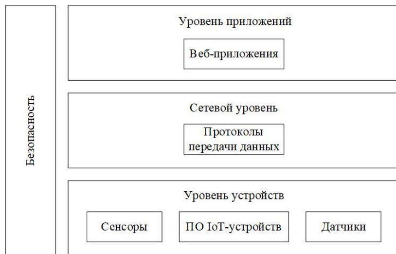
Рисунок 1 – Архитектура Интернета вещей
