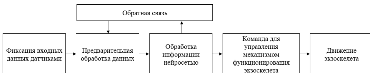
Рисунок 1 – Обобщенная схема интеллектуальной системы управления активным экзоскелетом (с применением нейронных сетей)
