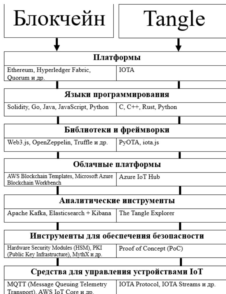
Рисунок 1 – Необходимые инструменты для реализации концепций Блокчейна и Tangle в IoT
