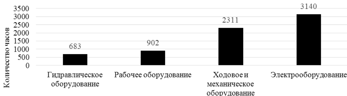
Рисунок 3 – Среднее количество часов до выхода оборудования из строя
