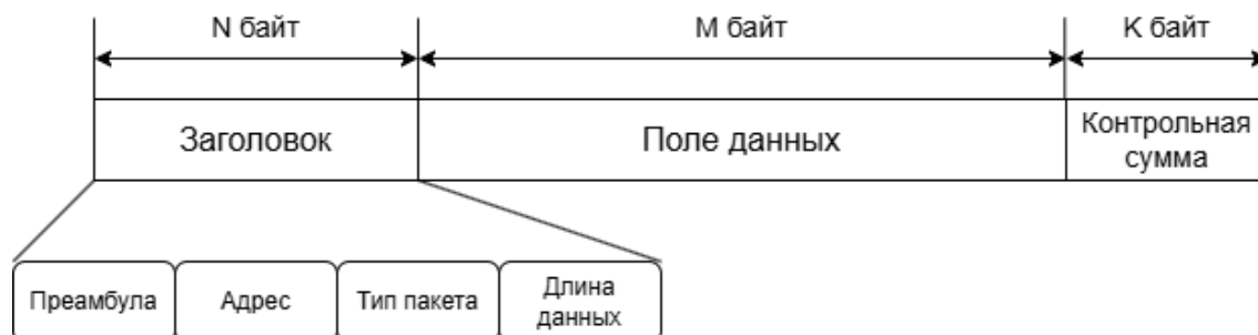
Рисунок 1 – Структура типового пакета
