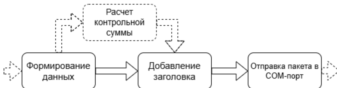
Рисунок 6 – Общая схема отправки пакета
