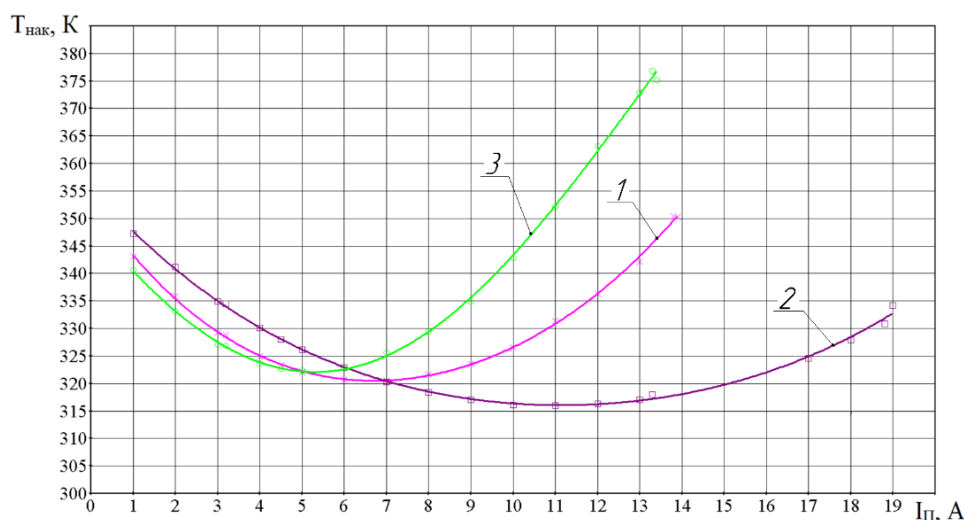
Рисунок 3 — Температура диодов накачки: 1 – XLT2385; 2 – XLT2389; 3 – XLT2393.
