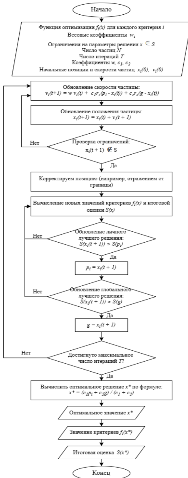
Рисунок 2 – Алгоритм решения МКО с использованием метода WSW и PSO
