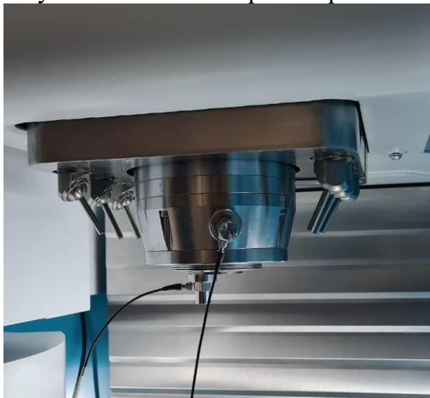
Рисунок 10 - ШУ на станке вместе с датчиками
