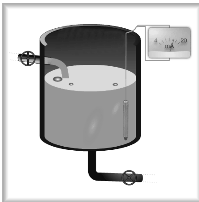
Рисунок 2 – Строение гидростатического уровнемера
