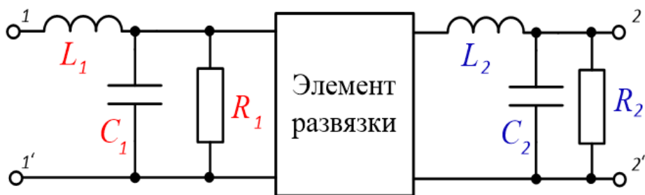
Рисунок 4 — Функциональная схема фильтра нижних частот
