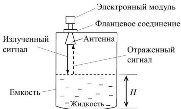
Рисунок 5 – Строение радарного уровнемера
