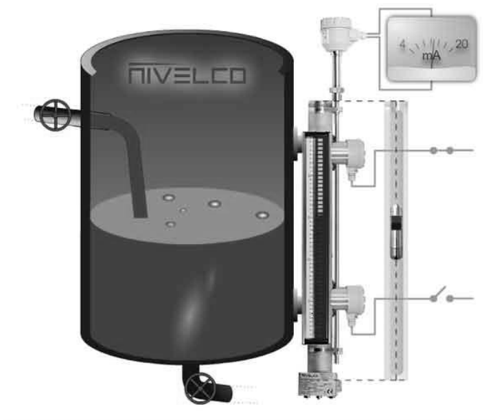
Рисунок 3 – Строение байпасового уровнемера
