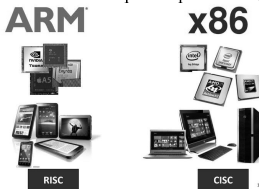
Рисунок 3 – Примеры ARM и x86 процессоров
