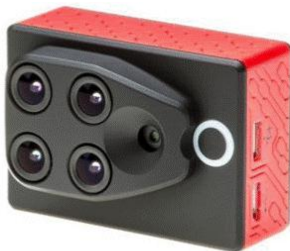
Рисунок 2 – Внешний вид мультиспектральной камеры Parrot Sequoia
