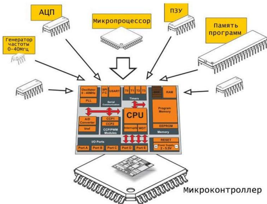
Рисунок 1 — Типовая функциональная схема микроконтроллера
