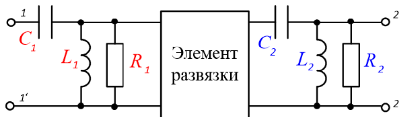
Рисунок 1 — Функциональная схема фильтра верхних частот
