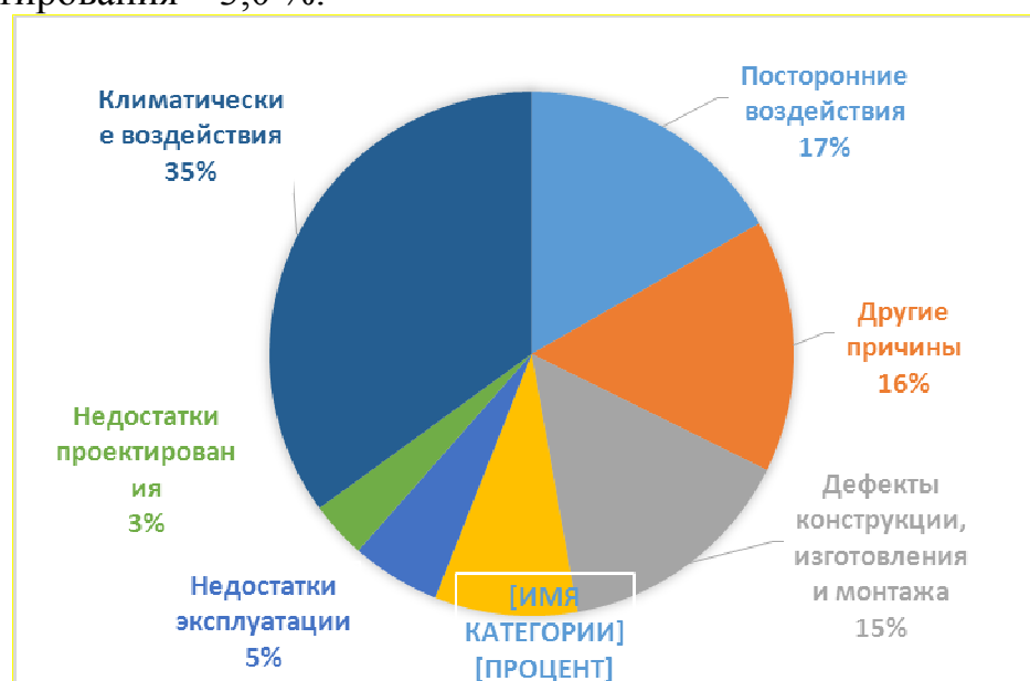
Рисунок 1 – Причины отказа изоляторов ЛЭП
