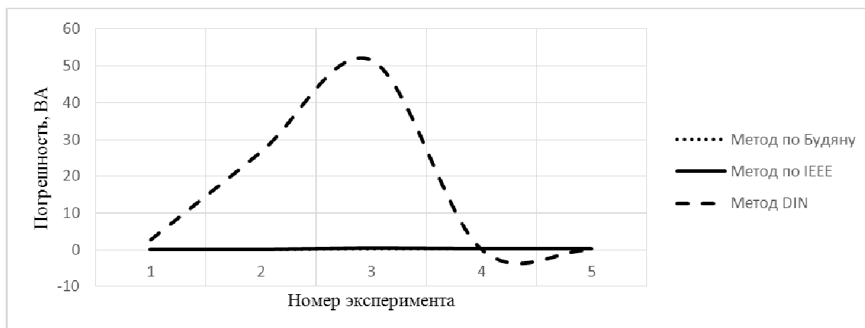
Рисунок 1 – Разность значений расчётной и реальной мощностей при наличии в сети третьей гармоники
