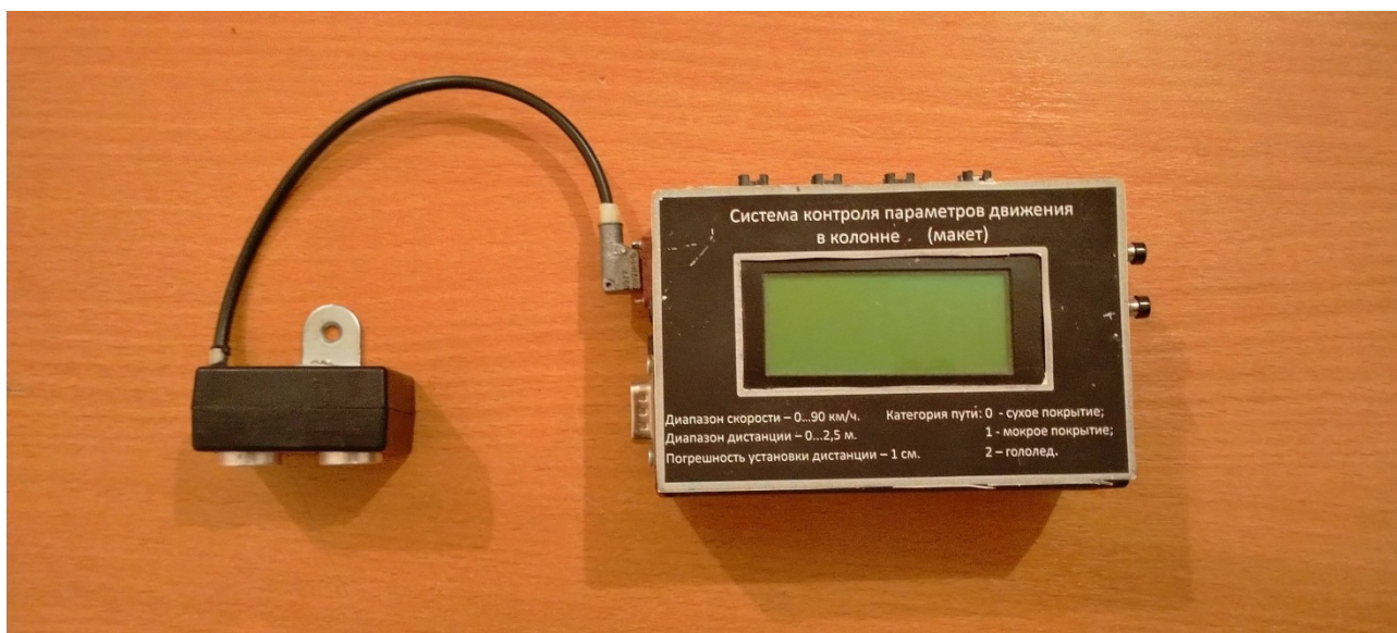
Рис.2. Прототип системы (блоки ввода-вывода, ЖК-дисплей и контроллер в корпусе, УЗ-датчик)
