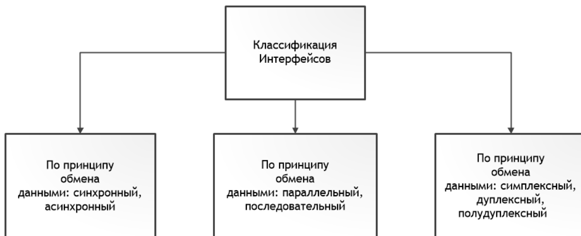
Рисунок 1.1 – Классификация интерфейсов для передачи данных
