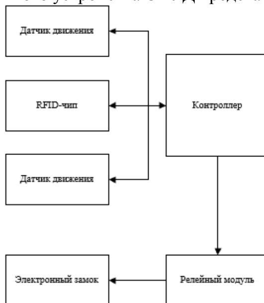
Рисунок 1.2. Структурная схема устройства контроля и управления доступом в помещении
