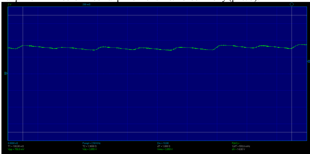
Рисунок 5 — Осциллограмма напряжения, снятая после выпрямителя, с емкостью конденсатора 2,2 мкФ
