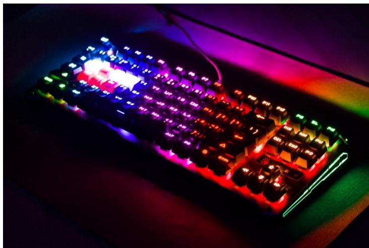
Рисунок 1 — Клавиатура с RGB подсветкой, цвет которой может изменяться только по заранее заданному алгоритму
