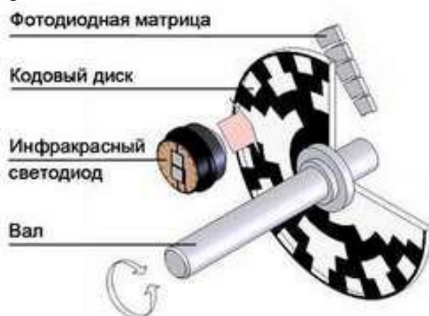
Рисунок 8 — Измерительная система абсолютного оптического энкодера
