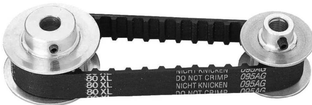
Рисунок 3 — Устройство ременной передачи
