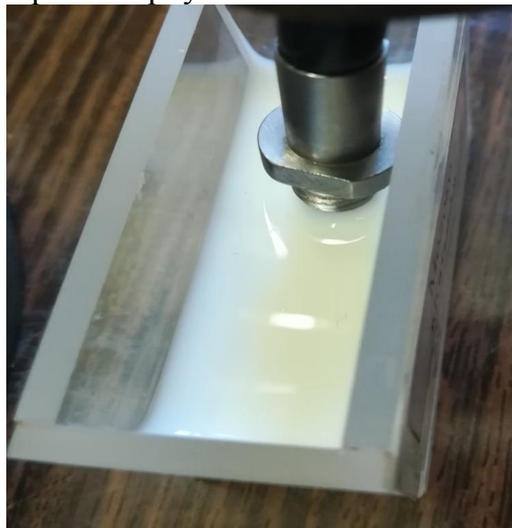
Рисунок 1 – Волоконнооптический кабель спектрофлуориметра, помещенный в молоко
