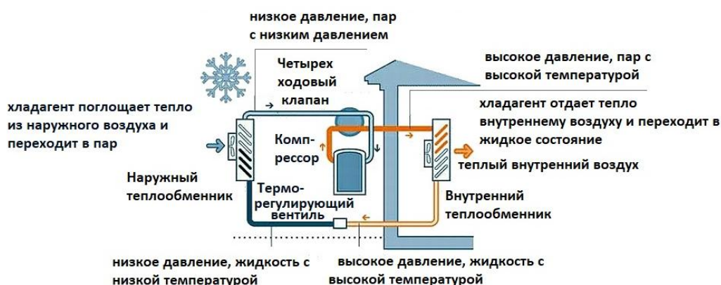
Рисунок 1– Схема обогрева и охлаждения с помощью теплового насоса
