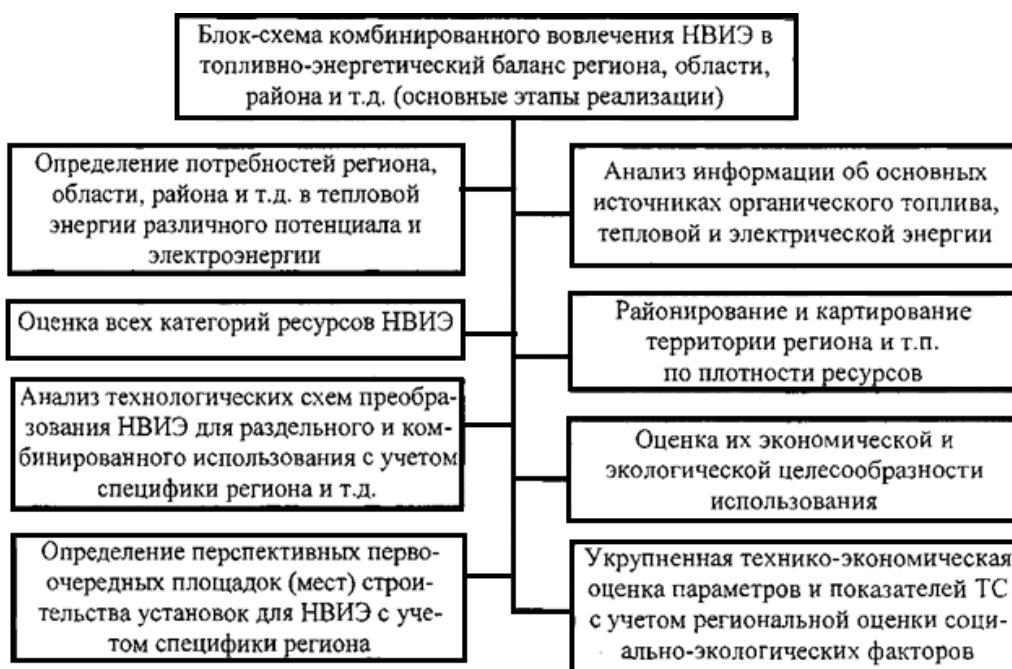
Рисунок 1. Структурная схема комплексного использования НВИЭ в топливно-энергетический баланс отдельного региона.
