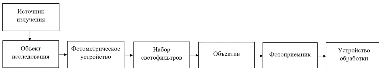
Рисунок 2. Принцип работы колориметра
