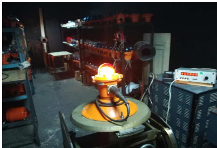
Рисунок 2 – Лабораторный стенд для измерения светотехнических параметров исследуемых ламп
