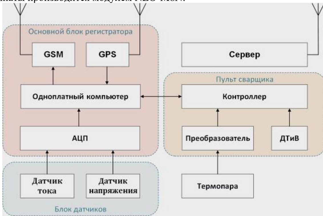
Рис.2. Структурная схема сбора и передачи данных в автоматизированной системе
