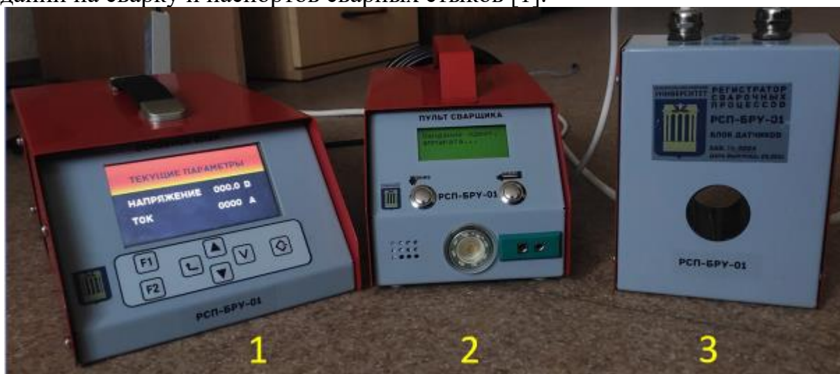
Рис.1. Регистратор сварочных процессов: 1- основной блок, 2- блок сварщика, 3- блок датчиков
